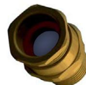
Предотвращают попадание внутрь оболочки посторонних предметов через кабельные вводы и обеспечивают защиту от внешних воздействий не ниже IP66. Устанавливаются внутри кабельного ввода, перед уплотнительным кольцом. Совместно со взрывозащищенным оборудованием могут применяться, только как средство защиты при транспортировке и хранении до начала монтажа, без обеспечения взрывозащиты. Материал изготовления - никелированная латунь.
