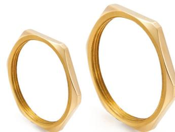
Предназначены для фиксации кабельных вводов, переходников, адаптеров и заглушек в сквозных отверстиях оболочек оборудования. В условиях повышенных вибраций, совместно с зубчатыми шайбами обеспечивают надежную защиту от самоотвинчивания. Материал изготовления: латунь, никелированная латунь, нержавеющая сталь.
