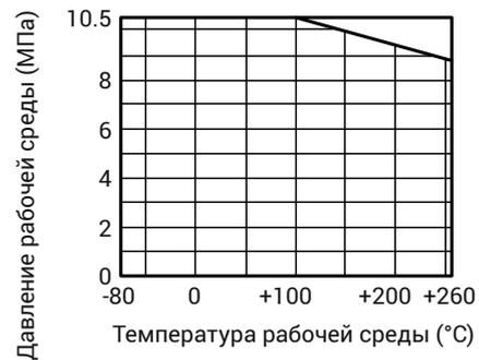
Допустимый перепад давления клапана, сальник V-PTFE, класс герметичности IV (таблица 4-1)
