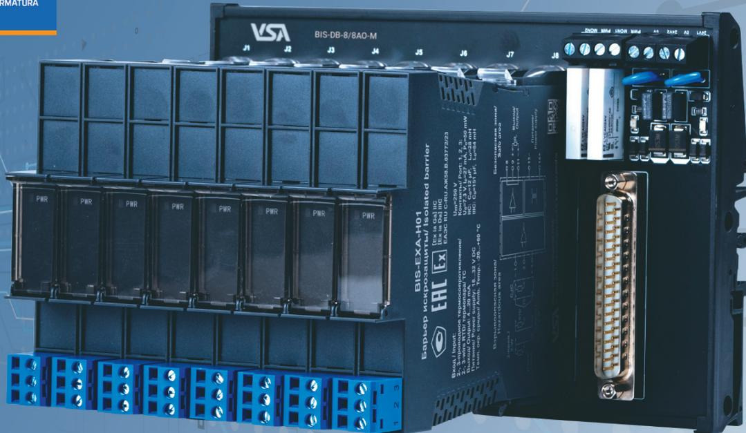
Барьеры искрозащиты выполняют функцию преобразователя измерительного или изолятора гальванического и используются в качестве разделительных элементов между искробезопасными и неискробезопасными цепями, обеспечивая безопасность работы приборов и датчиков, находящихся во взрывоопасных зонах.
